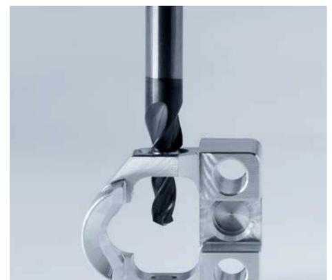
An diesem Aluminium Bauteil konnten zwei Arbeitsgänge eingespart werden: Reiben der Bohrung und anschließendes mechanisches Entgraten.
